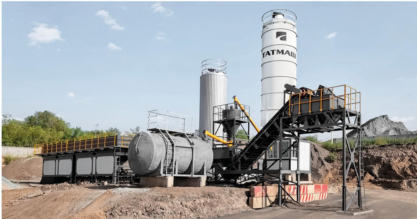
Базовая комплектация установки Standard-300 включает в себя: агрегат питания, двухвальный смеситель непрерывного типа, системы подачи цемента, воды и битумной эмульсии, бункер готовой смеси, кабину оператора.
